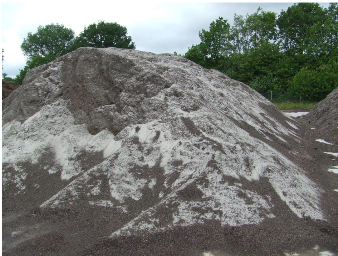
Abb. 4: Aus dem Seegrass ausgesiebter Sand lagert auf der Kompostierungsanlage, bis er an den Strand zurücktransportiert wird. Die Verunreinigung durch nicht ausgesiebte, feine Seegrassstückchen ist erkennbar (Foto: Michael Packschies)
