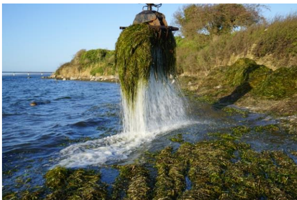
Abb. 2: Das Seegras wird direkt am Ufer aus dem flachen Wasser gebaggert, so haftet fast kein Sand am Seegras. (Foto: Jörn Hartje)
