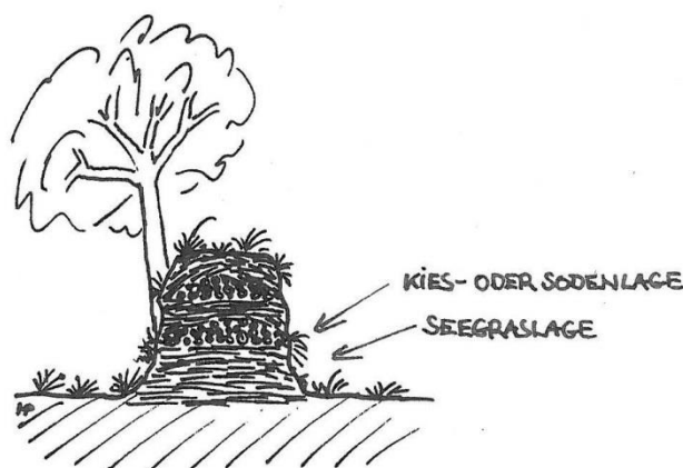
Abb. 1: Freistehender Seegraswall, z. T mit Zwischenlagen aus Strandkies; Funktionen: Hochwasserschutz, Feldgrenze, Gemeindegrenze; Beispielorte: Falsterbo, Skanör, Møn, Nyord, Skarø, Ebeltoft (Eigene Grafik)
